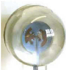
ILA pour communication indoor à 62GHz.
